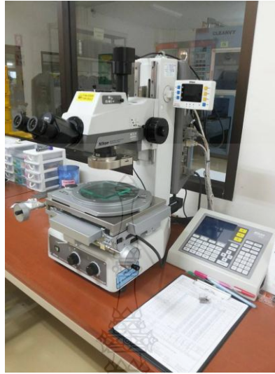
รูปที่ 3.8 กล้องจุลทรรศน์วัดขนาด ยี่ห้อ Nikon รุ่น MM-400 (DP-E1)
