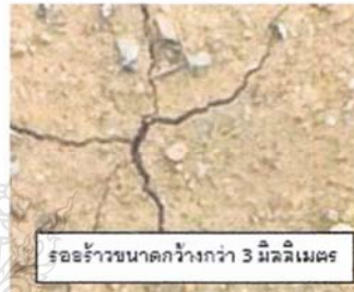
รูปที่ 6 ความรุนแรงของรอยร้าวในแปลงควบคุม
