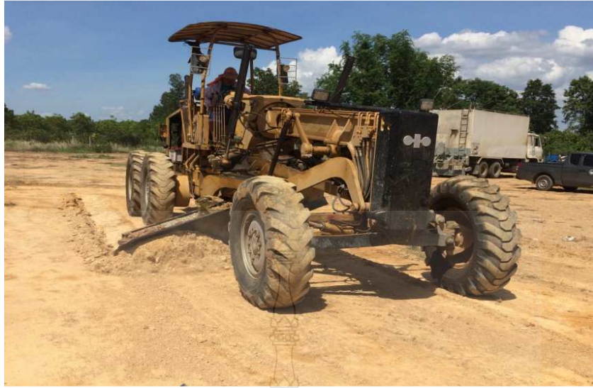
รูปที่ 3.5 ลักษณะของรถเกรดเดอร์ที่ใช้ในงานก่อสร้างทั่วไป
