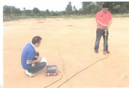
รูปที่ 3 การทดสอบความแข็งแรงพื้นทางด้วย LWD
