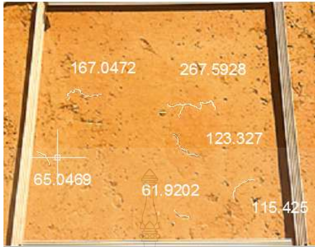
รูปที่ 4.7 ความยาวของรอยร้าวในพื้นที่ 1 ตารางเมตรจากแปลงควบคุมที่อายุ 3 วัน
