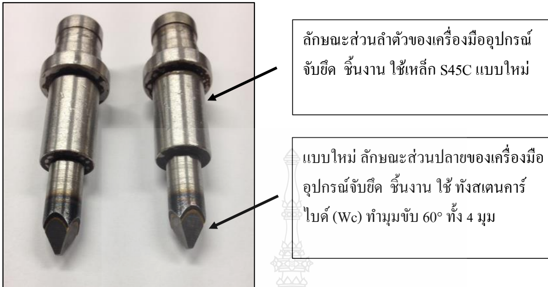
รูปที่ 4.3 เครื่องมืออุปกรณ์จับยึดชีงงานช่วยในการขันหมุนแบบใหม่
