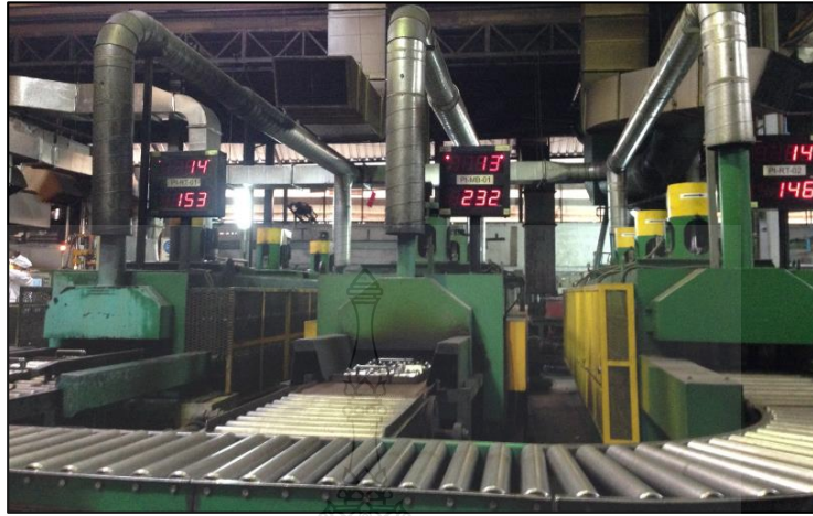
รูปที่ 3.7 ขั้นตอนการอบชิ้นงาน
