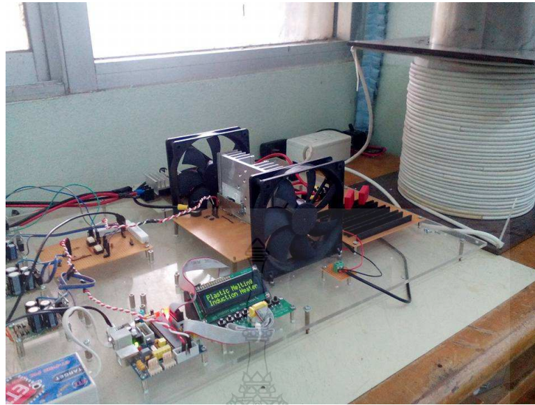
รูปที่ ก.1 ชุดวงจรกำลังและขดลวดเหนี่ยวนำความร้อนที่ใช้ทดสอบในห้องปฏิบัติการ ขนาด 1 kw
