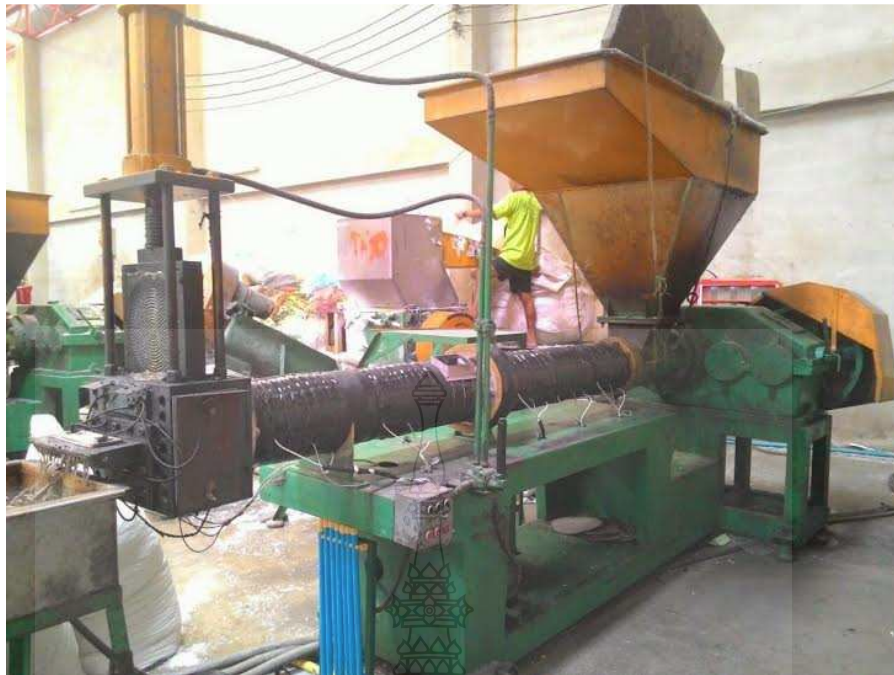
รูปที่ 4.15 การทดสอบหลอมพลาสติกด้วยขดลวดความร้อนแบบเหนียวในงานอุตสาหกรรม
