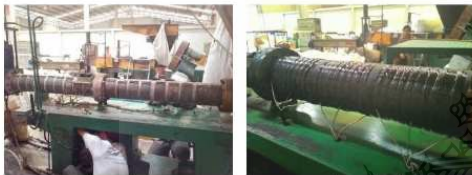
(ก) เดิมใช้ลดความร้อนแบบรีดท่อม (ข) ขดลวดเหนียวที่ติดตั้งแล้วเสร็จ รูปที่ 8 ก่อนและหลังติดตั้งการใช้ขดลวดเหนียวนำความร้อน
