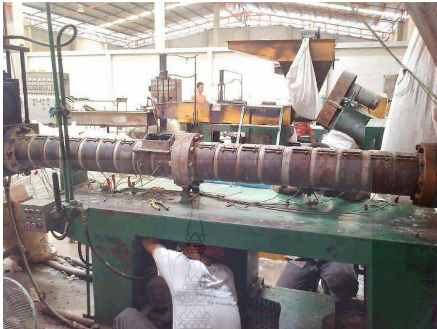
รูปที่ 4.14 การทดสอบหลอมพลาสติกด้วยขดลวดความร้อนแบบรัดท่อในงานอุตสาหกรรม
