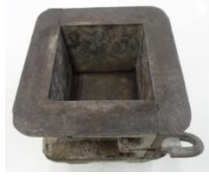
รูปที่ 3.5 แบบหล่อคอนกรีตขนาด 100 x 100 x 100 มม.
