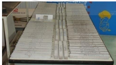
รูปที่ 3.4 ชั้นตัวอย่างมอร์ตาร์ที่บ่มในอากาศที่อุณหภูมิห้องเฉลี่ย 30 \pm 2^{\circ}\text{C}
