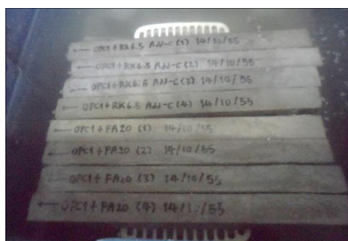
รูปที่ 3.13 ชิ้นตัวอย่างมอร์ตาร์ที่แช่ในสารละลายโซเดียมซัลเฟต
