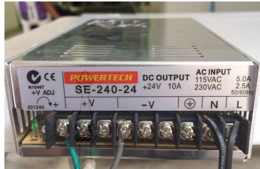
รูปที่ 3.5 แหล่งจ่ายไฟ (Power Supply) แบบดีซี 24 V และมีกระแสตรง 10 A
