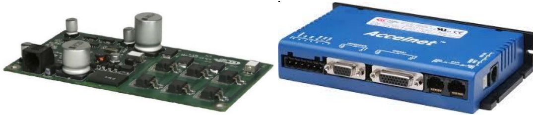
รูปที่ 3.3 ชุดขับมอเตอร์รุ่น Accelus card (ซ้าย) และ Accelnet Pael (ขวา)
