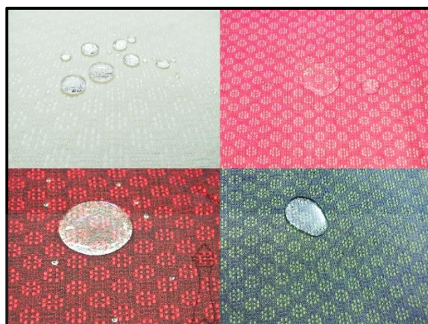
รูปที่ 4.5 การสะท้อนน้ำของผ้ายกเมืองนคร
