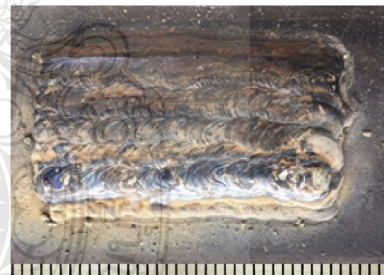
ง) พอกผิวแข็งที่กระแสเชื่อม 100 A อุณหภูมิระหว่างเทียวเชื่อม 350 °C
