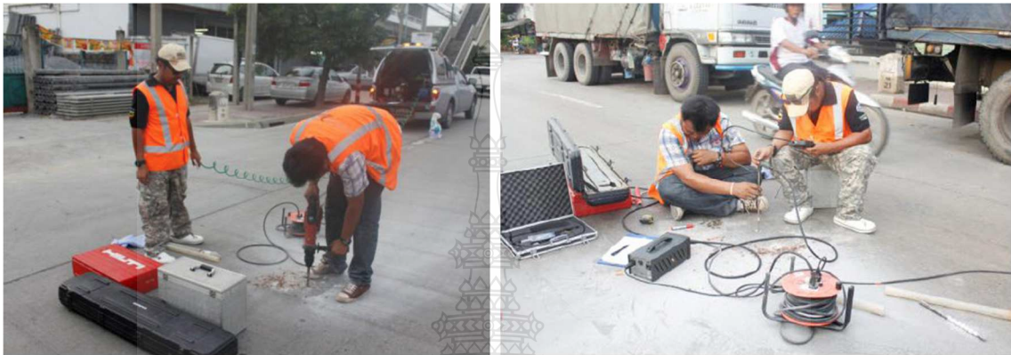
รูปที่ 3.2 เครื่องมือเจาะและสำรวจ Bore Scope
