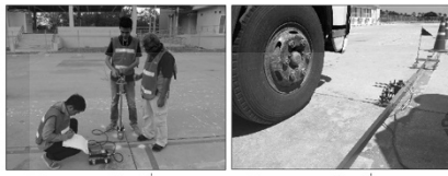
รูปที่ 9 การทดสอบด้วยเครื่อง LWD และ Port-LTE
