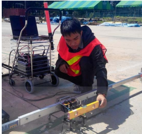
รูปที่ 3.7 วัดระดับของอุปกรณ์วัดค่าการยุบตัวด้วยไม้ระดับน้ำ
