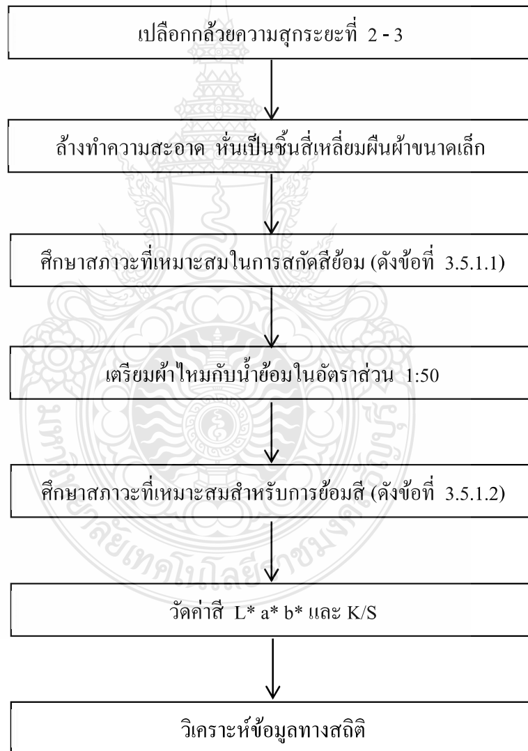
รูปที่ 3.1 กระบวนการสกัดสี้อมและย้อมสีผ้าไหมจากเปลือกกล้วยน้ำว้าดิบ
