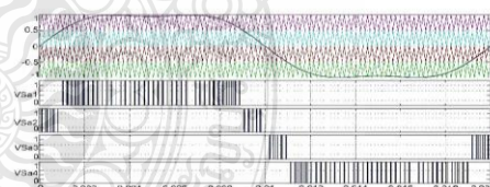
รูปที่ 14 สัญญาณมอดูเลชันของ HIPWM บน APOD
