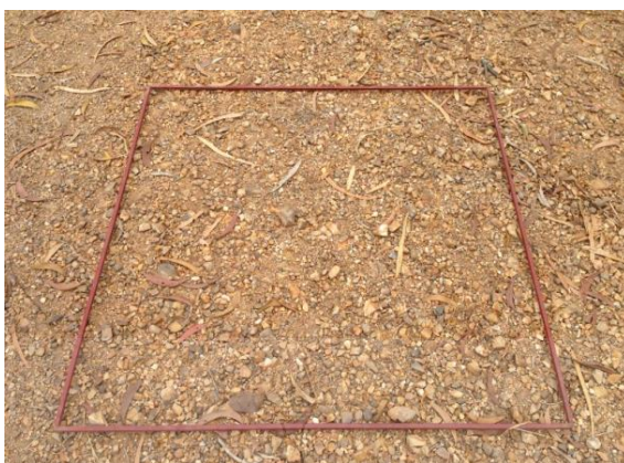
รูปที่ 3.1 กรอบเก็บข้อมูลขนาด 100 เซนติเมตร x 100 เซนติเมตร
