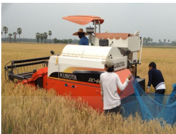
รูปที่ 3.24 การเก็บข้อมูลที่ช่องทางออกฟางของรถเกี่ยวนาขณะทำการทดสอบ
