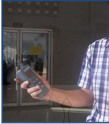
รูปที่ 3.5 การวัดความเข้มข้นก๊าซคาร์บอนไดออกไซด์และความชื้นสัมพัทธ์
