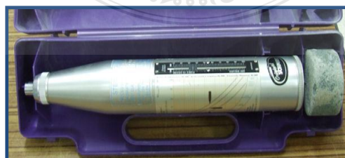
รูปที่ 2.4 เครื่องมือรีบาวด์แฮมเมอร์ (Schmidt Rebound Hammer)
