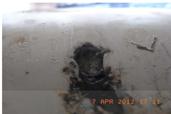
ภาพที่ 2.11 การผุกร่อนของท่อส่งปิโตรเลียมใต้ดิน [8]
