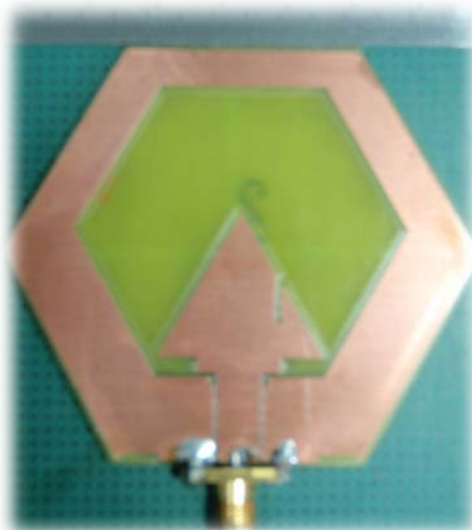
รูปที่ 3.23 ชิ้นงานสายอากาศร่องหกเหลี่ยมด้านเท่าที่ป้อนด้วยสายนำสัญญาณระนาบร่วมแบบแถบความถี่กว้างที่พัฒนาเพิ่มประสิทธิภาพโดยใช้เทคนิคช่องว่างแถบแม่เหล็กไฟฟ้า (EBG)
