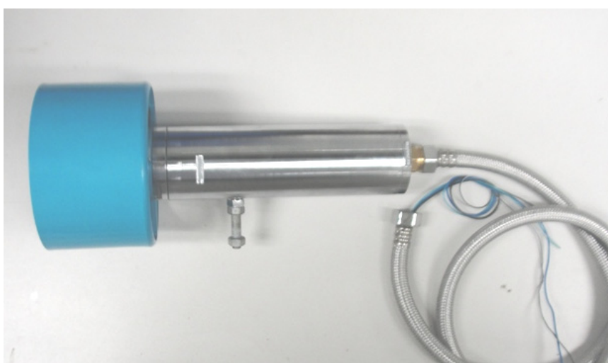
รูปที่ 3.3 ชุดผลึกที่ได้จากการออกแบบเพื่อใช้กับยานใต้น้ำ BENBAN-G2
