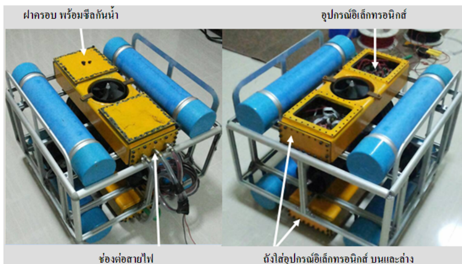
รูปที่ 3.18 ถังบรรจุอุปกรณ์อิเล็กทรอนิกส์และการติดตั้ง
