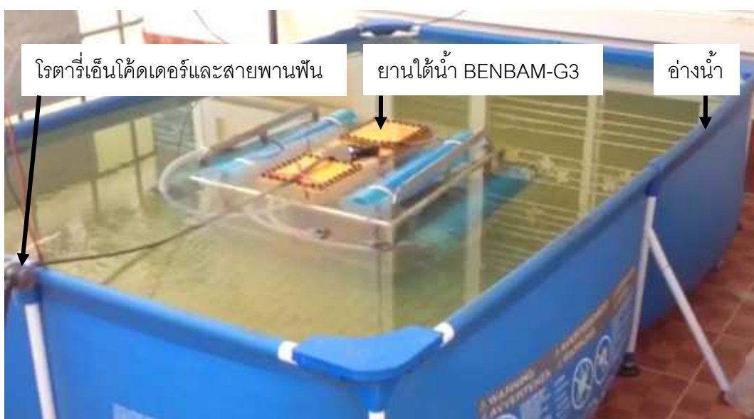
รูปที่ ฉ.1 การติดตั้งอุปกรณ์ทดสอบการควบคุมความเร็วหน้า-หลัง และซ้าย-ขวา
