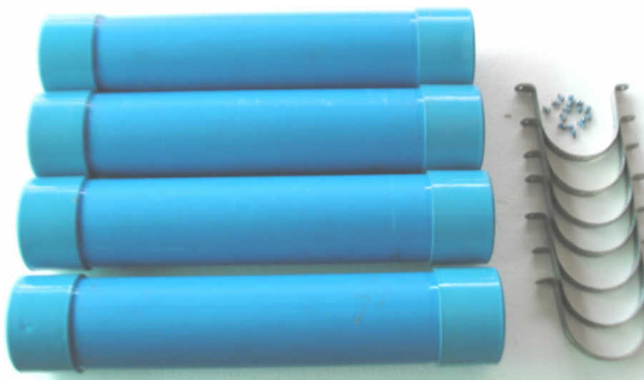
รูปที่ 3.9 ถังเพิ่มแรงลอยตัวที่ได้จากการออกแบบ
