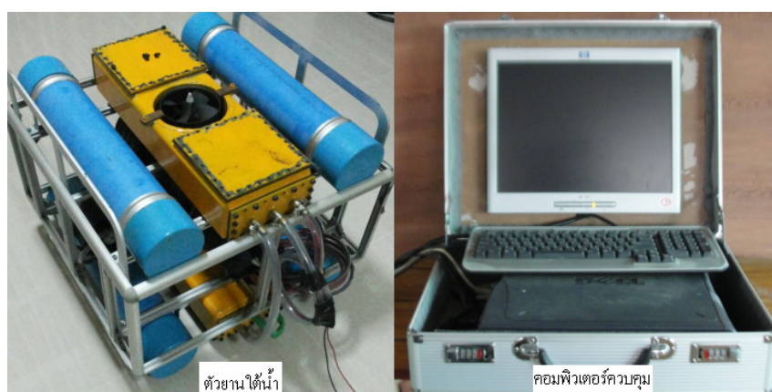
(ข) ยานใต้น้ำหลังปรับปรุงจากการออกแบบครั้งแรก (BENBAM-G3)
