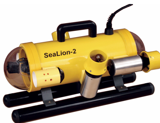
รูปที่ 2.18 ยานใต้น้ำ SeaLion-2 โดย JW Fishers Mfg [18]
