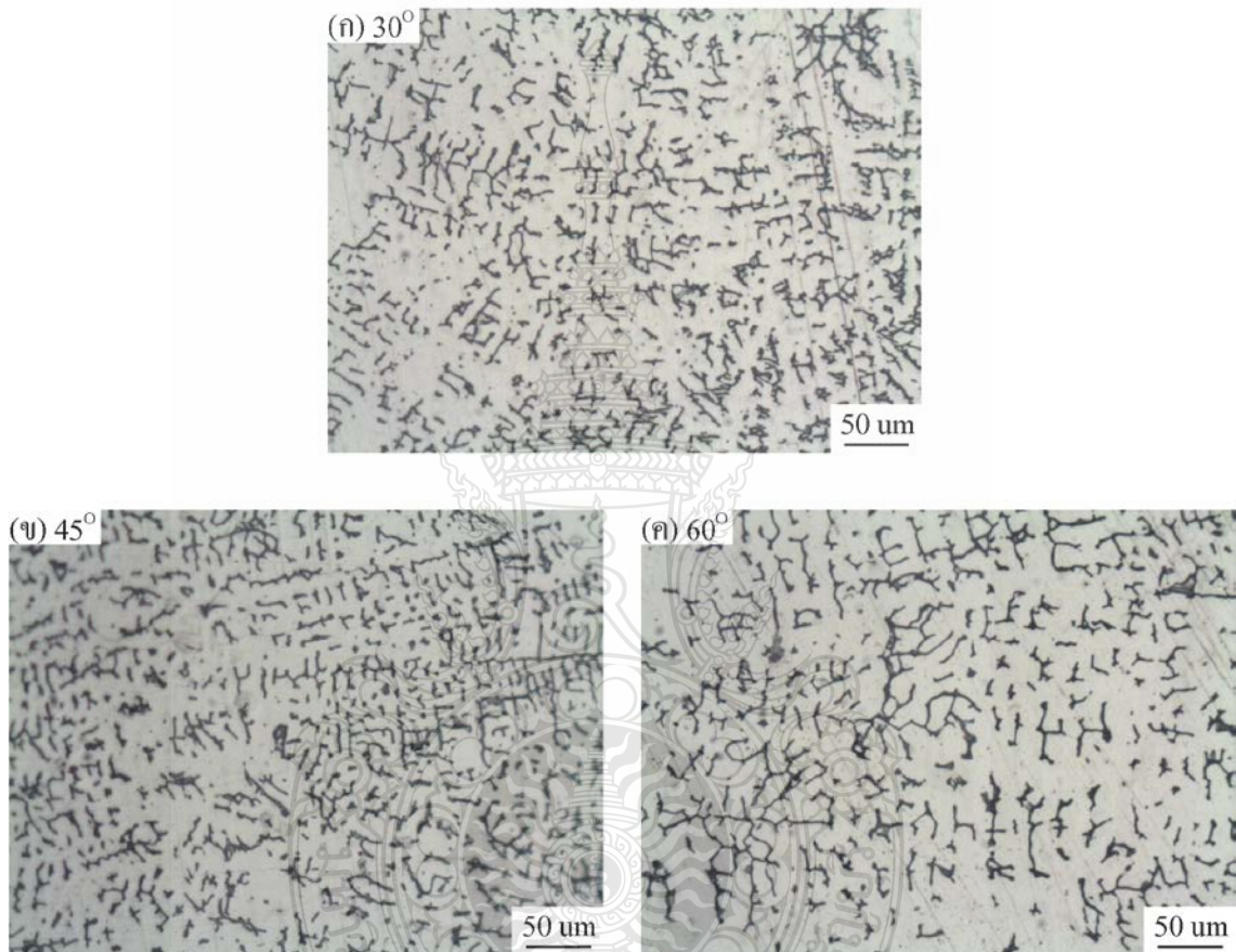
รูปที่ 4.18 การเปรียบเทียบ โครงสร้างบริเวณฉีกขาดที่มุมเชื่อมต่างกัน
