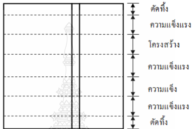
รูปที่ 3.8 ลักษณะการตัดชิ้นงานทดสอบ
