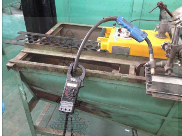
รูปที่ 3.4 ลักษณะการวัดกระแสในการเชื่อม
