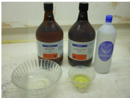
(ก) กรดที่ใช้ในการกัดผิวชิ้นงาน
