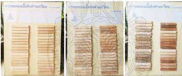
ภาพที่ 2 แผ่นทดลองเนื้อดินปั้นด้านเกวียน เผาที่อุณหภูมิ 900,1100,1200 องศาเซลเซียส
