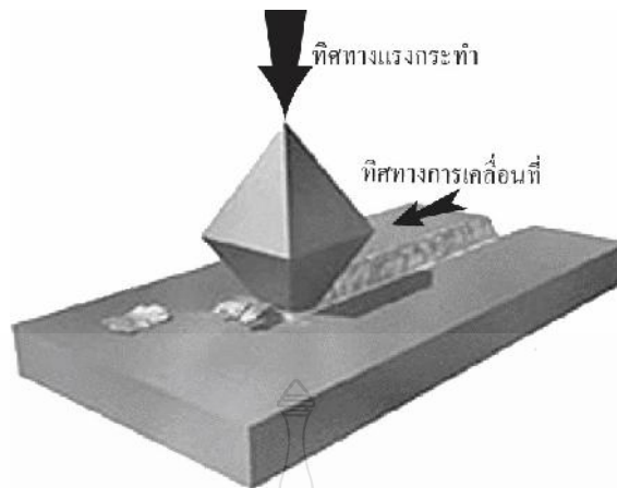
รูปที่ 2.8 ลักษณะการสึกกร่อนที่เกิดจากการกัดเซาะ[13]
