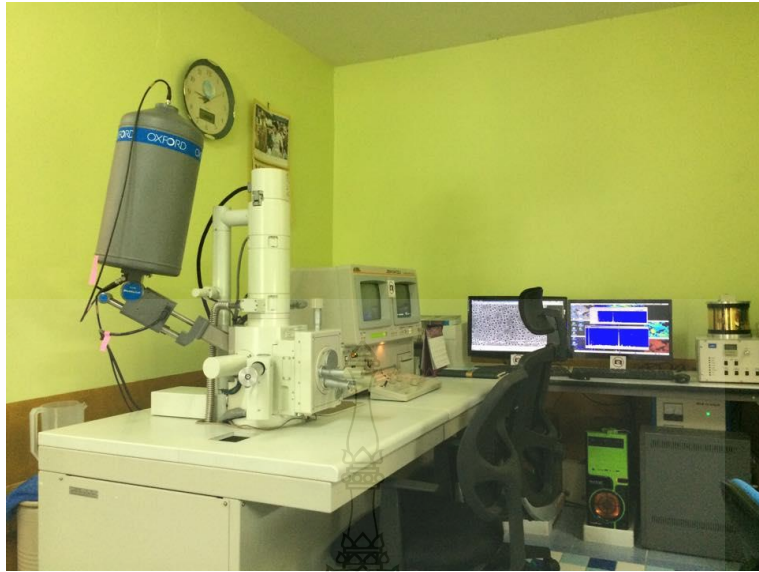
รูปที่ 3.18 กล้องจุลทรรศน์อิเล็กตรอนชนิดส่องกราด Scanning Electron Microscope SEM
