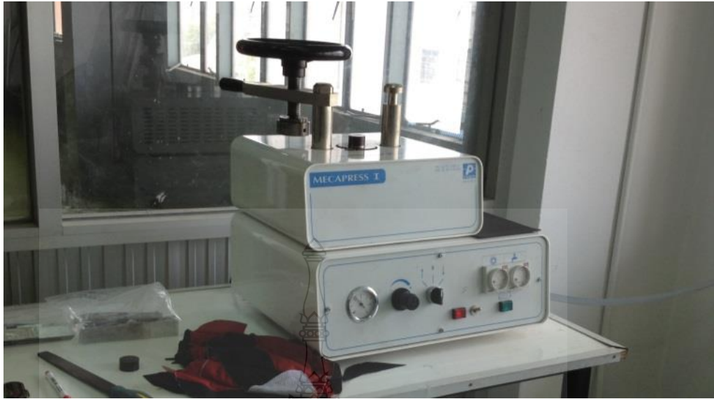
รูปที่ 3.13 เครื่องหล่อเรซินขนาดเส้นผ่านศูนย์กลาง 1 นิ้ว
