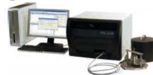
รูปที่ 4 เครื่องทดสอบการนำความร้อน TCA รุ่น TPS 2500S ผลิตโดยบริษัท Therm Test Inc.
