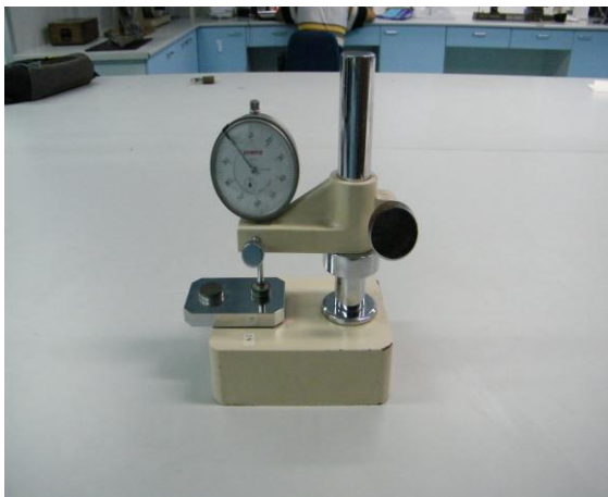
รูปที่ 3.6 เครื่องทดสอบความหนาบางของชิ้นทดสอบ ยี่ห้อ PEACOCK รุ่น 207
