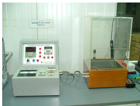
รูปที่ ข.4 เครื่องทดสอบ Thermal Conductivity Testers ASTM D1518
