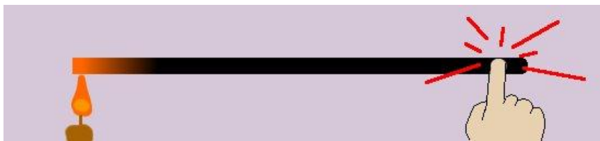
รูปที่ 2.1 ลักษณะการนำความร้อนของแท่งโลหะ [3]
