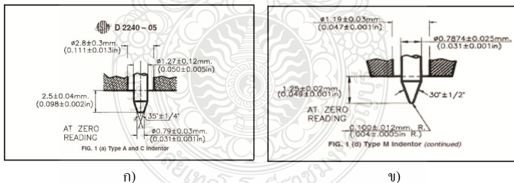
รูปที่ 2.13 แสดงลักษณะของคูโรมิเตอร์ (ก) Shore A และ(ข) Shore D [5]
