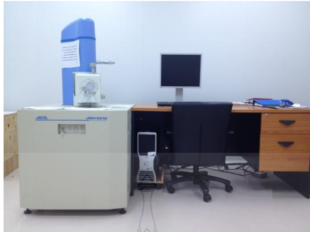
รูปที่ 3.10 กล้องจุลทรรศน์อิเล็กตรอนแบบส่องกราด ยี่ห้อ JEOL รุ่น JSM-6510
