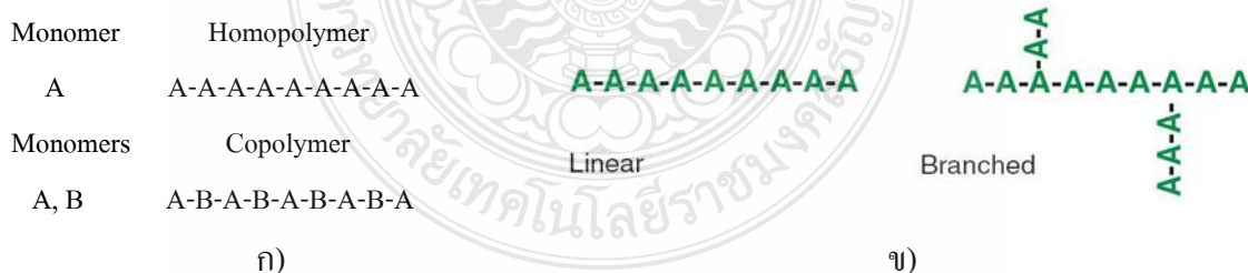
รูปที่ 2.1 ก) แผนภาพโครงสร้างโซโม่พอลิเมอร์และ โคพอลิเมอร์ ข) แผนภาพโครงสร้างเชิงเส้นและแบบมีกิ่งก้านหรือสาขา [3]
