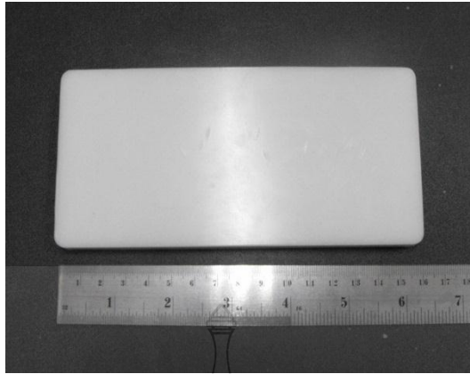
รูปที่ 3.5 ลักษณะแผ่นขึ้นทดลองวัสดุ UHMWPE ที่ผ่านการอัดขึ้นรูปร้อน
