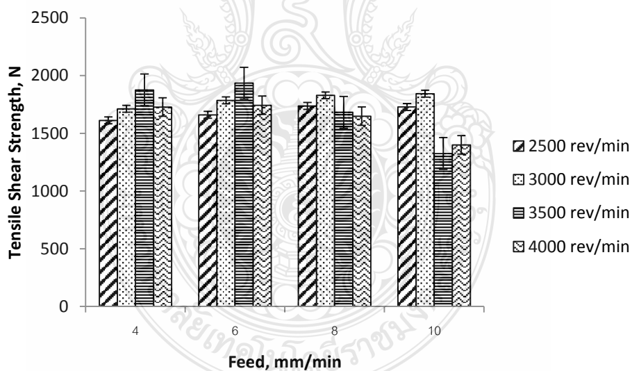
รูปที่ ข4 ความแข็งแรงดึงเฉือนของรอยเชื่อมที่ความเร็ว 4 8 6 10 มม./นาที เครื่องมือเชื่อม T4 ความเร็วรอบในการเชื่อม 2500 3000 3500 4000 รอบ/นาที
