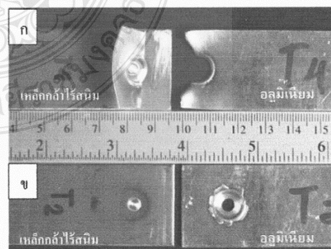
รูปที่ 6 การฉีกขาดของชิ้นทดสอบแรงดึงเดือน: (ก) รอยต่อที่มีความแข็งแรงสูงสุด และ (ข) รอยต่อที่มีความแข็งแรงต่ำสุด
