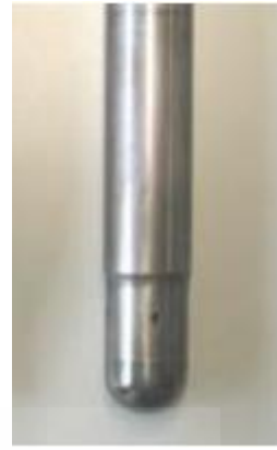
รูปภาพที่ 2 ทูลสำหรับกดขึ้นรูป ปลายรูปทรงกลม ขนาด 8 มิลลิเมตร
