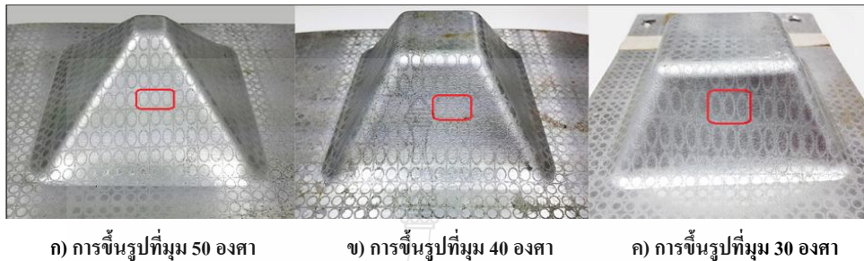
ภาพที่ 4.30 การยึดตัวของแผ่น โลหะอลูมิเนียมหลังการขึ้นรูปที่ความเร็วในการหมุนของเครื่องมือ 200 รอบต่อนาที ที่มุม 30, 40 และ 50 องศา
