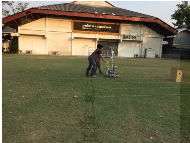
รูปที่ 4.19 ขณะตรวจพบสิ่งกีดขวางในพื้นที่การทำงานที่ระยะ 4 เมตร เมื่อมีสิ่งกีดขวางห่างจากจุดเริ่มต้นเป็นระยะทาง 8 เมตร
