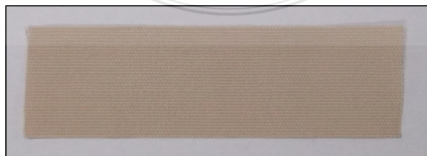
ภาพที่ 3.10 ชิ้นงานที่ใช้ทดสอบขนาด 40 X 100 มิลลิเมตร
