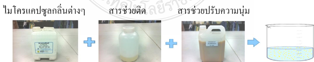
ภาพที่ 3.4 ขั้นตอนการผสมสารเคมี
