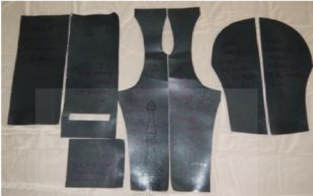
ภาพที่ 3.18 วิธีการวางแบบตัดผ้าหุ้มเบาะ บนผ้าฝ้ายผสมสเปนเด็กซ์
