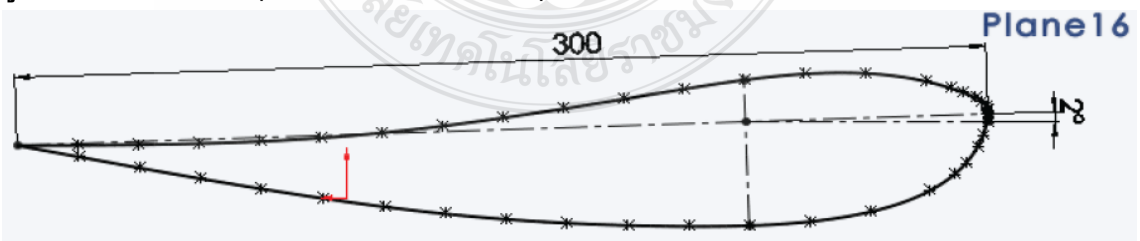
รูปที่ 3.3 ภาพตัดขวางมุมบิด โคนใบ Plant 3 ทำมุม 8 องศา
