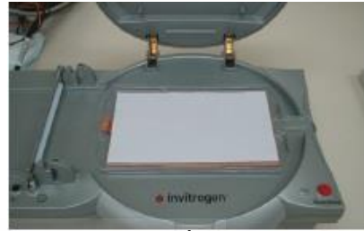
วาง Bottom stack ซึ่งมีแผ่น membrane ลงบนตัวเครื่อง โดยไม่ต้องนำพลาสติกออก
