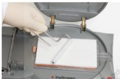
นำกระดาษกรองแช่น้ำกลั่น วางลงบนแผ่นเจล และไล่ฟองอากาศออกให้หมดโดยใช้ Roller
