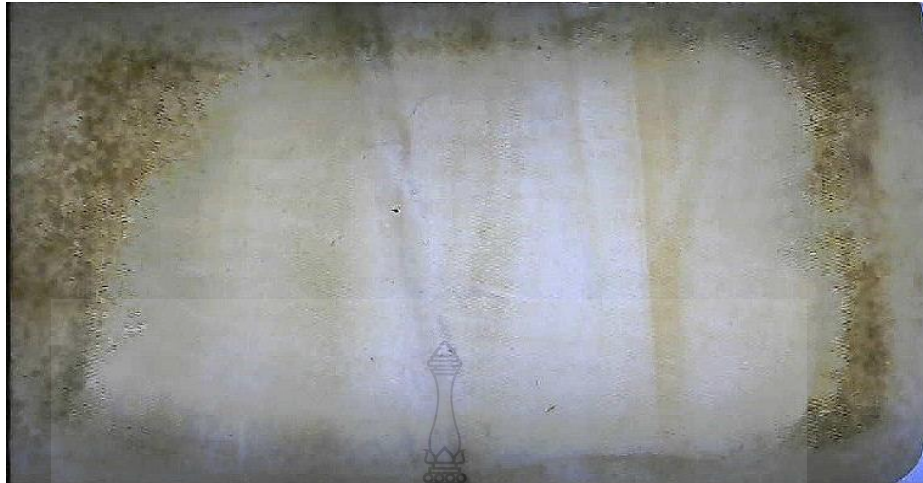
ภาพที่ 3.28 ตัวอย่างขางพาราแผ่นรมควันชั้น 5 โดยผ่านการใช้กระบวนการ unsharp mask ของระดับสี RGB
