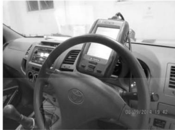
ภาพที่ 1 เครื่องวิเคราะห์ปัญหา Intelligent Tester II และรถยนต์ที่ใช้ในการทดสอบ
