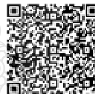
ภาพที่ 2.4 ตัวอย่างของการเข้ารหัสคิวอาร์โค้ดโดยข้อมูลที่เข้าเป็นข้อมูลประเภทตัวอักษรและตัวเลขที่มีขนาดความยาวของข้อมูล 300 ตัวอักษร
