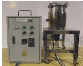
รูปที่ 2 อุปกรณ์ในการสังเคราะห์ด้วยกระบวนการไฮโดรเทอร์มอล
