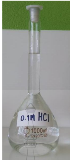
ภาพที่ 3.15 การเตรียมสารละลายกรดไฮโดรคลอริก (HCl) เข้มข้น 0.1 M
