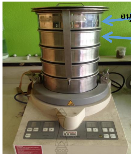
รูปที่ 3.6 แสดงเครื่อง เครื่องคัดแยกขนาด (Vibratory Sieve Shaker)
