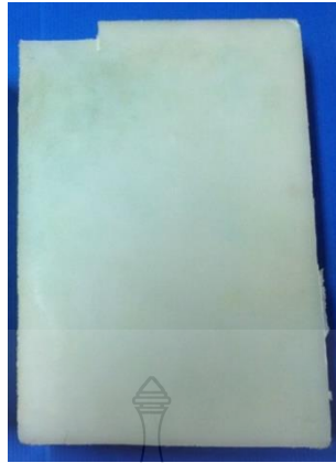
รูปที่ 4.10 ผลจากการขึ้นรูป LLDPE ที่อุณหภูมิ 240 °C ที่เวลา 10 นาที
