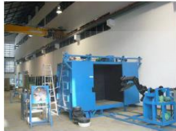
รูปภาพที่ 1 แสดงเครื่องขึ้นรูปพลาสติกแบบหมุน ชนิด Shuttle-Style ที่ใช้ในรูปชิ้นงานทดสอบ
