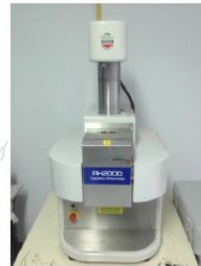
รูปภาพที่ 3 แสดงเครื่องทดสอบสมบัติการไหล (Capillary Rheometer)
