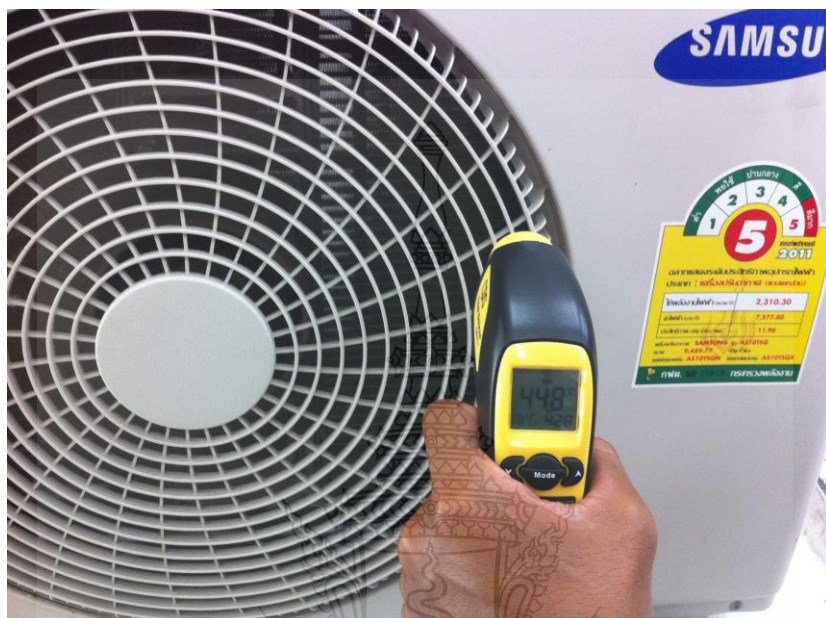
ภาพที่ 3.12 ตรวจสอบอุณหภูมิด้านหน้าชุดคอนเดนเซอร์ของเครื่องปรับอากาศ
