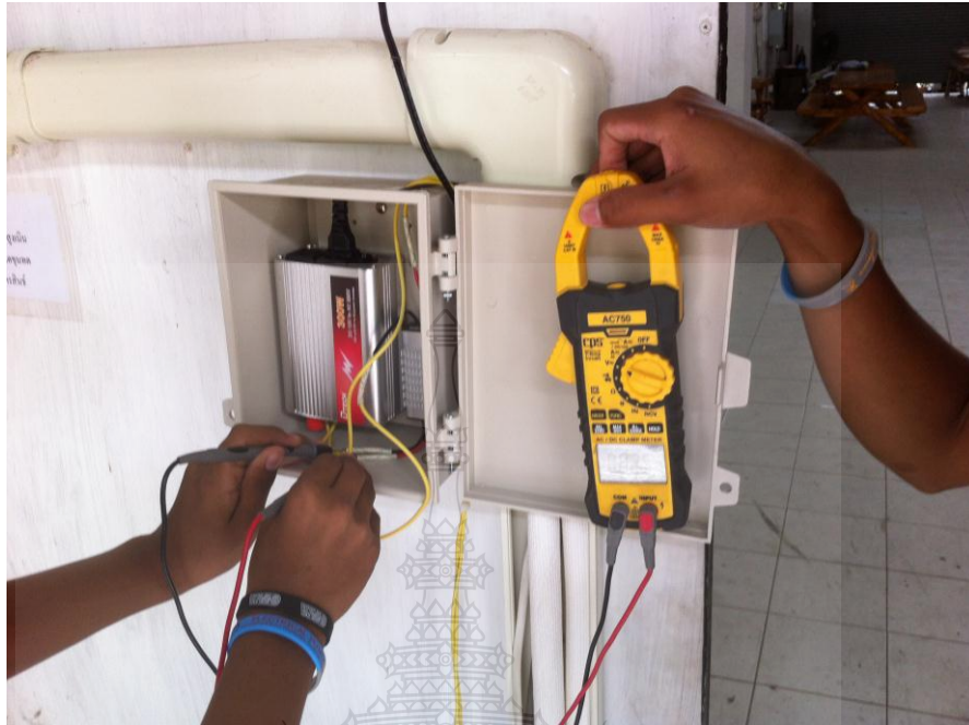
ภาพที่ 3.25 บันทึกและเก็บข้อมูลการผลิตไฟฟ้าชุดสาธิตขณะที่เครื่องปรับอากาศทำงาน
