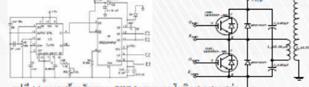
รูปที่ 14 วงจรสร้างสัญญาณ PWM และวงจรโซลิตเดสททส่า
