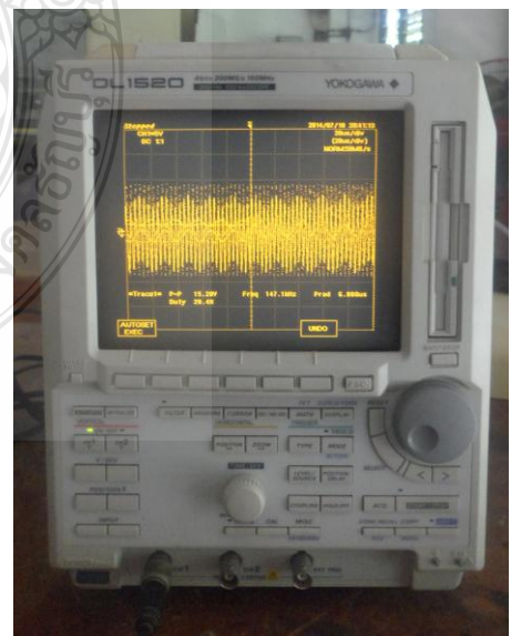
ภาพที่ 4.29 คลื่นสัญญาณแรงดันไฟฟ้าด้านแรงดันสูง ที่วัดด้วยวิธี Voltage divider
