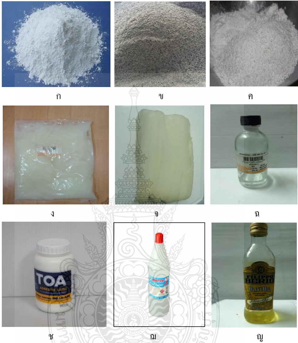
ภาพที่ 3.1 วัสดุที่ใช้เป็นส่วนผสมดินปั้นเก้าแกลบ (ก) ดินขาว (ข) เก้าแกลบ (ค) แป้งข้าวเหนียว (ง) วาสลิน (จ) ไมโครเว็กซ์ (ฉ) สารกันบูด (ช) กาวลาเท็กซ์ (ฌ) กาวน้ำ (ญ) น้ำมันมะกอก
