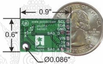
รูปที่ 3.5 เข็มทิศแบบดิจิทัล (Digital Compass) [9]
