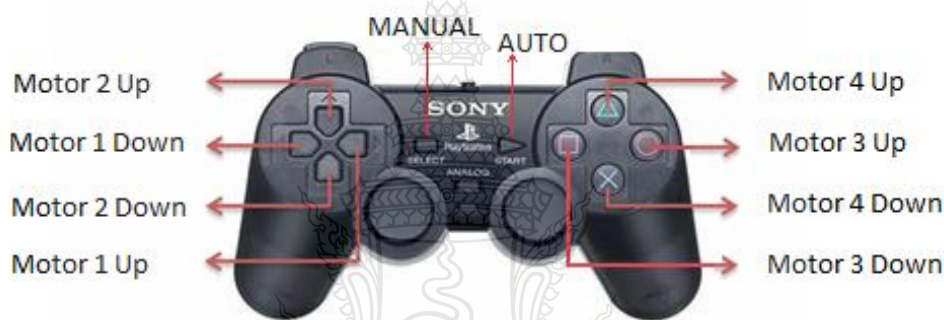
รูปที่ 4.18 แผนภาพการบังคับมอเตอร์ขับเคลื่อนของหุ่นยนต์ค้ำน้ำด้วยจอยสติ๊ก
