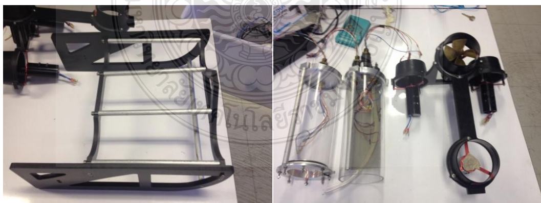
รูปที่ 4.15 การประกอบโครงสร้างของหุ่นยนต์ดำน้ำ (ซ้าย) การประกอบชุดมอเตอร์ขับเคลื่อนและถังใส่อุปกรณ์อิเล็กทรอนิกส์ (ขวา)
