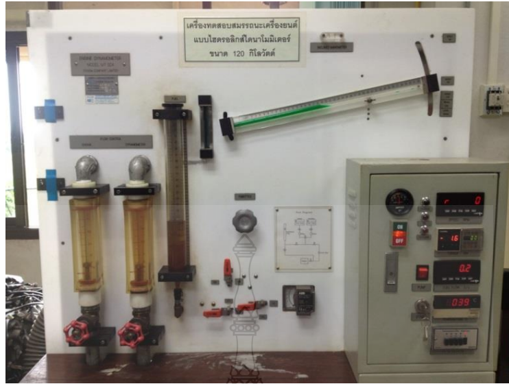
รูปที่ 3.10 แผงควบคุมแสดงแรงบิดเครื่องยนต์
