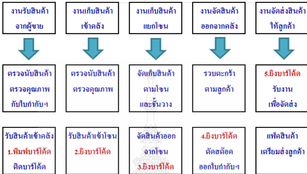
ภาพที่ 2.3 ผังงานรวมระบบงานฝ่ายคลังสินค้าและจัดส่ง
