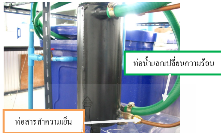
รูปที่ 3.25 การติดตั้งอุปกรณ์แลกเปลี่ยนความร้อนแบบท่อร่องเกลียว
