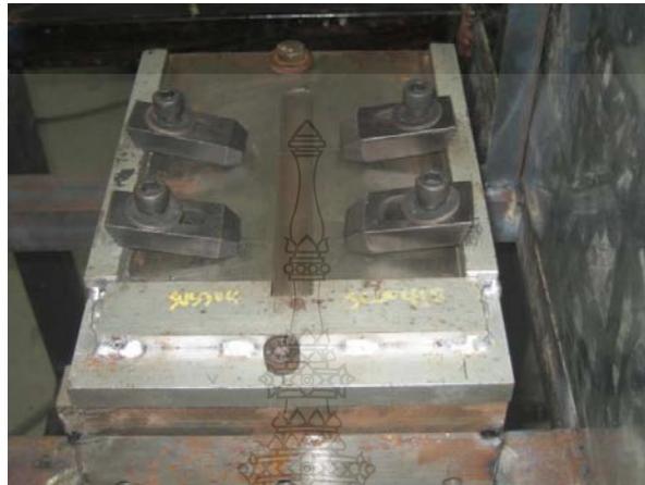
รูปที่ 3.2 อุปกรณ์จับยึดชิ้นงานในการเชื่อม
