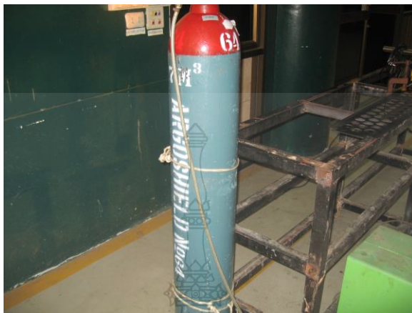
รูปที่ 3.4 แก๊สปกคลุมอาร์โกซีด 64 ที่ใช้ในการเชื่อม
