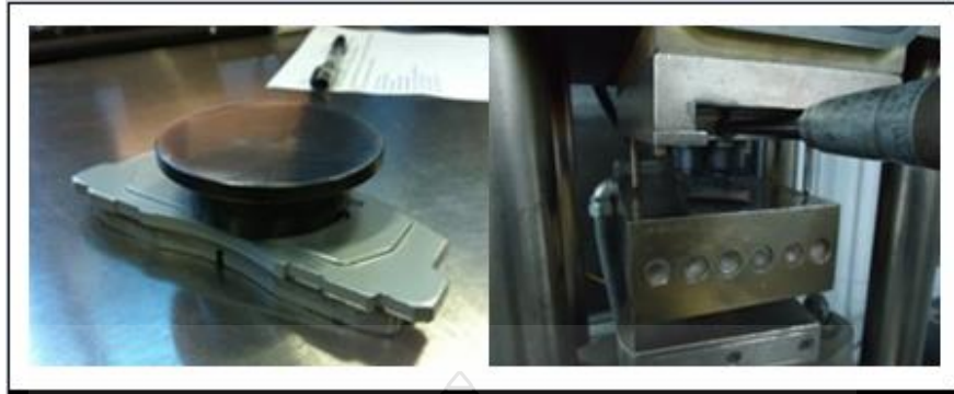
รูปที่ ข.4 แบบจำลองลูกสูบ (Piston) สำหรับใช้ทดสอบแรงอัด (Compression Test)
