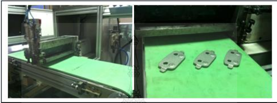
รูปที่ 4.5 การเคลือบกาว (Adhesive Coating) บนเหล็กทรงหลัง
