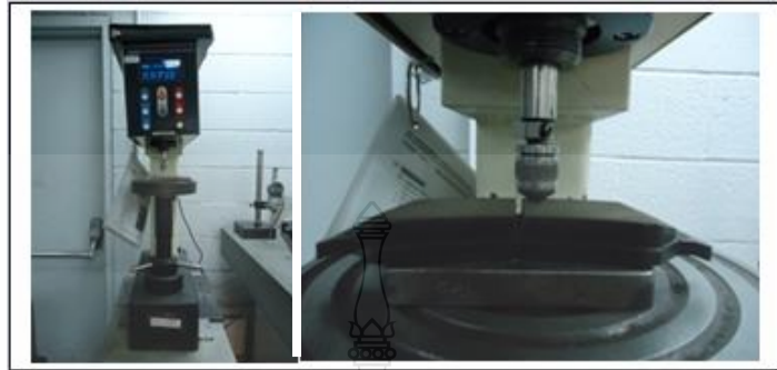
รูปที่ 4.19 เครื่องทดสอบความแข็งผิวหน้าผ้าเบรค (Rockwell Hardness: HRR)
