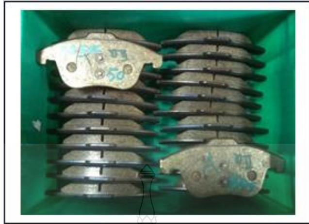
รูปที่ 4.51 ชิ้นงานที่ทำการผลิตที่ระยะเวลาการอัด 90 วินาทีและ 130 วินาที
