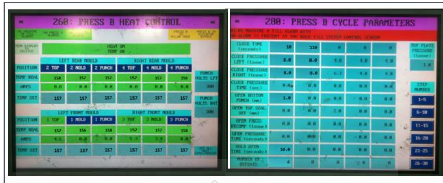
รูปที่ 4.65 การปรับตั้งอุณหภูมิและพารามิเตอร์ที่เครื่องขึ้นรูปรีออน
