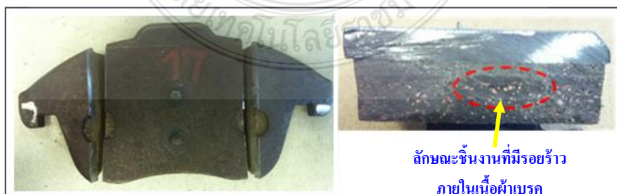
รูปที่ 4.29 ตัวอย่างชิ้นงานที่ตัดเพื่อดูรอยร้าวภายในเนื้อผ้าเบรค
