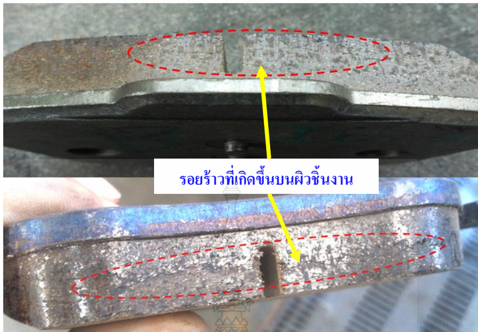
รูปที่ 4.58 ผิวของผ้าเบรค ก่อนการปรับปรุงชิ้นงานจะมีลักษณะรอยร้าวเล็กๆอยู่ทั่วไป
