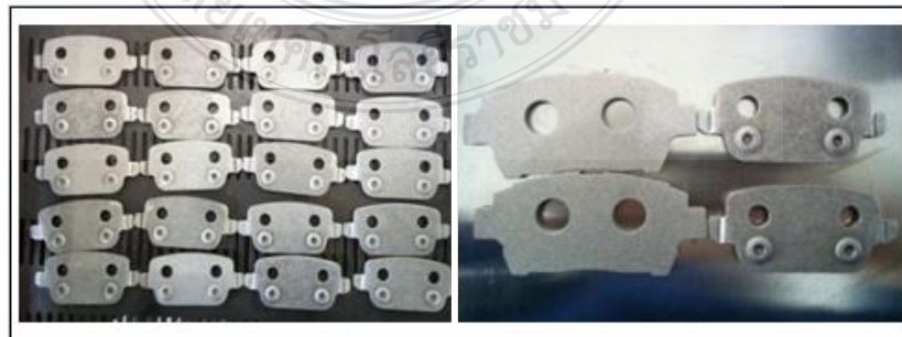
รูปที่ 4.4 ชิ้นงานหลังจากที่ผ่านกระบวนการยิงฝางานด้วยเม็ดเหล็ก
