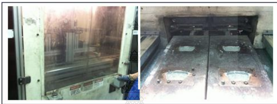
รูปที่ 4.11 การโหลดผงผ้าเบรคลงในแม่พิมพ์ก่อนที่จะทำการอัดขึ้นรูปร้อน
