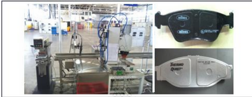
รูปที่ 4.17 เครื่องพิมพ์ข้อความ (Ink Jet Marking) และลักษณะตัวอย่างที่ผ่านการพิมพ์
