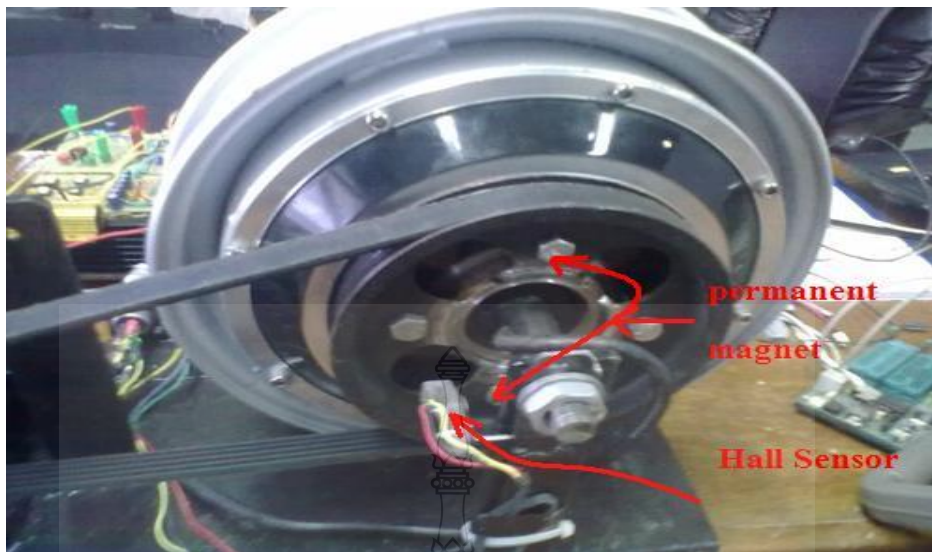
รูปที่ 3.20 ตำแหน่งติดตั้งแม่เหล็กถาวรและ Hall Sensor เพื่อตรวจจับความเร็วรอบมอเตอร์
