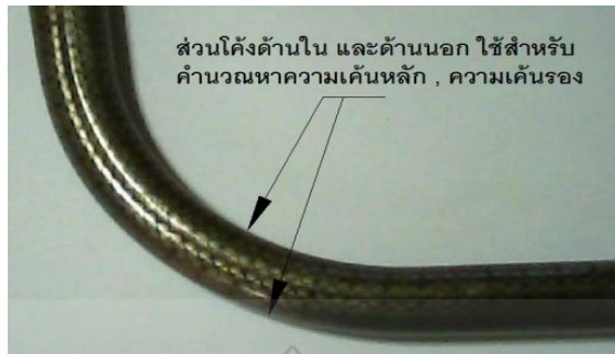
รูปที่ 3.29 ส่วนโค้งนอกและส่วนโค้งในของเหล็กท่อกดงที่จะนำมาคำนวณความเครียด [9]
