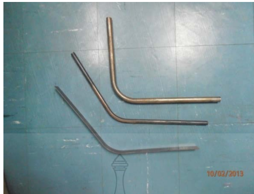
รูปที่ 4.24 ข้อบกพร่องทางกายภาพในกระบวนการตัดโดยใช้ใช้น้ำมันกึ่งสังเคราะห์ในเหล็กทั้ง 3 รูปทรง
