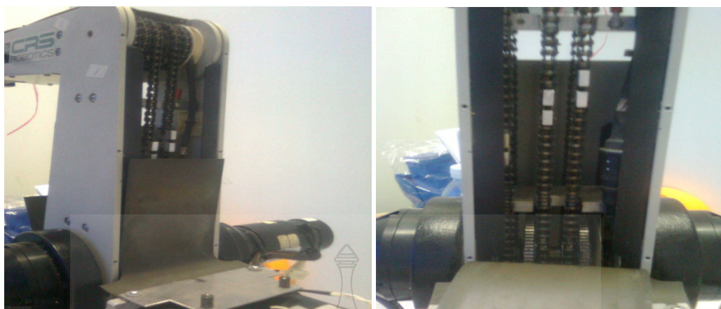
ภาพที่ 5.2 ชิ้นส่วนระบบส่งกำลังภายในของแขนกล CRS รุ่น A255
