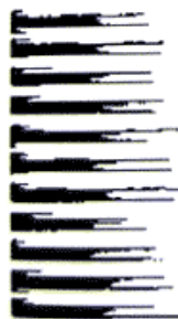
ภาพที่ 2.12 ภาพต้นแบบของภาพไม่เอียงและ Horizontal projection profile ของภาพ [4]
