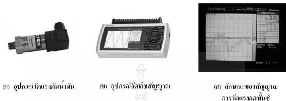
ภาพที่ 3.10 อุปกรณ์วัดแรงต้นและอุปกรณ์บันทึกแรงที่ได้จากการขึ้นรูป
