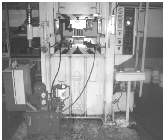
ภาพที่ 3.25 แม่พิมพ์พร้อมใช้งานติดตั้งบนเครื่องเพรสไฮดรอลิก
