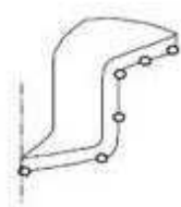
(ข) ชิ้นส่วนย่อยของถ้วยทรงกระบอกแสดงค่าความเครียดที่วัดได้
