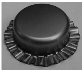
(ข) การขึ้นรูปด้วยของเหลวความหนืด 68 ที่ 100 bar
