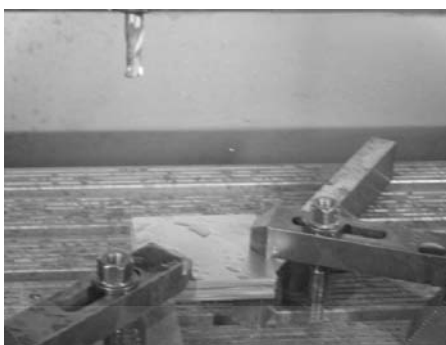
ภาพที่ 3.2 การจับยึด (Fixture) บนเครื่องกัด CNC
