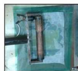
(ค) ตักขณะการขึ้นรูปกริดวง กลมโดยใช้ลูกกลิ้งกด
