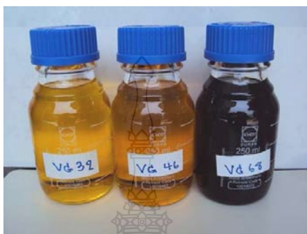
ภาพที่ 3.5 ของเหลวชนิดน้ำมันไฮดรอลิกตามมาตรฐานเกรด 32 46 และ 68
