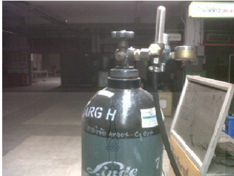
รูปที่ 3.3 ลักษณะของแก๊สที่ใช้ในการปกคลุมเชื่อม
