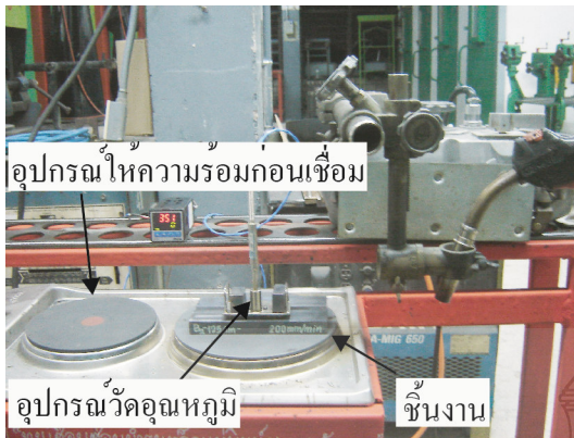
(ก) อุปกรณ์การให้ความร้อนชิ้นงานก่อนการเชื่อม (Preheated)
