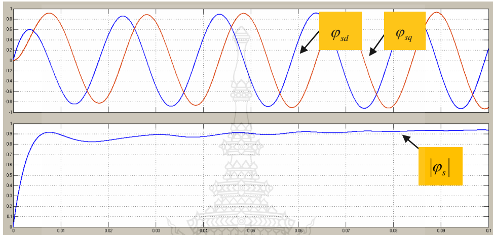
รูปที่ 3.30 รูปสัญญาณเส้นแรงแม่เหล็ก \varphi_{sd} และ \varphi_{sq} กับสัญญาณขนาดเส้นแรงแม่เหล็ก
